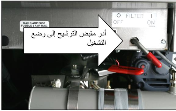
4. بعد تصريف الزيت من قدر القلي، أدر مقبض الفلتر إلى وضع ON (التشغيل) لبدء تشغيل المضخة وبدء عملية الترشيح. يمكن أن يحدث تأخير بسيط قبل أن تبدأ المضخة في العمل.
